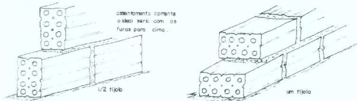
Figura 1 - Execução de alvenaria utilizando tijolos furados.
